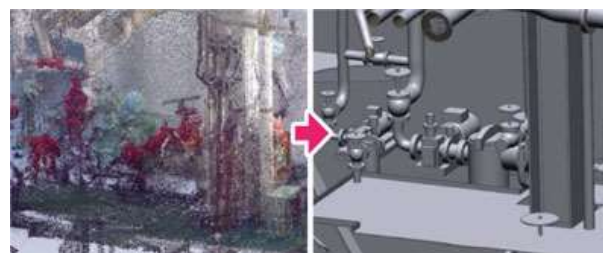
写真3. 3Dスキャンしたデータを解析ソフトでモデル化
